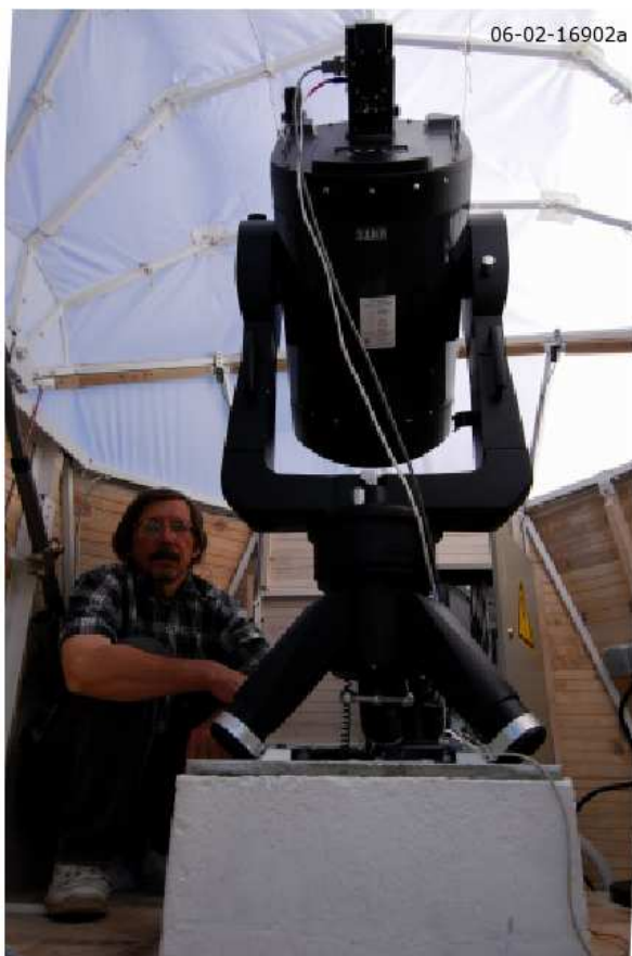
Рис. 2: Внутри купола астроклиматического монитора. На заднем плане — ящик со всей электроникой включая точку доступа, сетевой хаб, два компьютера, управляемый блок питания и контроллер купола. Антенна связи с ГАС ГАО закреплена снаружи на северной стороне. Телескоп RCX400 используется в альт-азимутальной установке.
