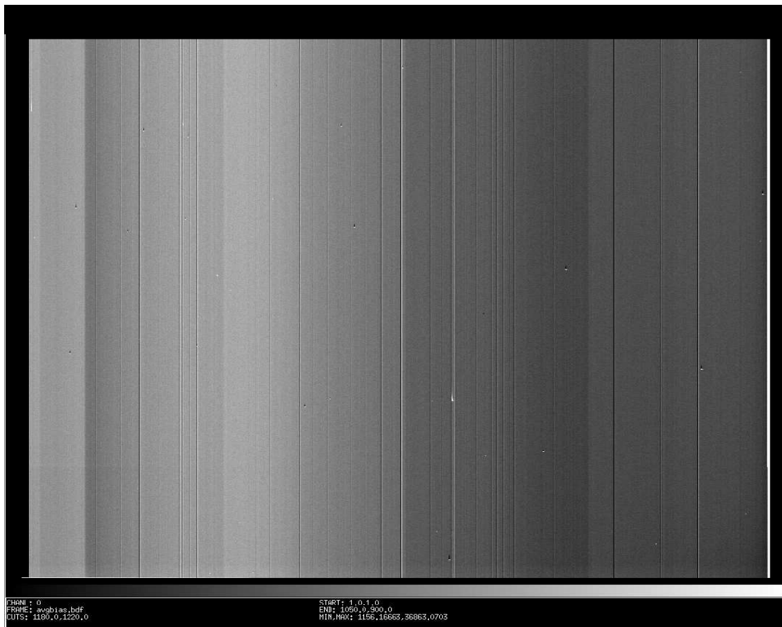
Рис. 2.2: Среднее изображение подложки ПЗС-камеры S1000 CAO РАН. Кадр усреднён из 13 групп подложек, усреднённых с отбросом выпадающих значений. Видны около 30 горячих пикселей и их групп.
